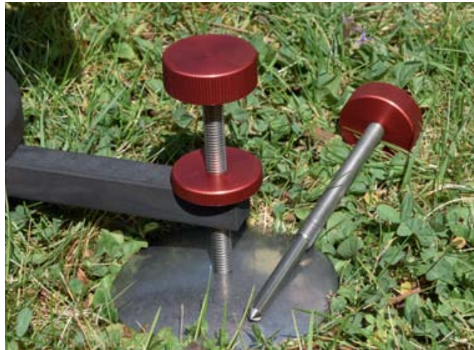
Die drei Füße der Mini Rest sind jeweils mit einer Justierschraube versehen, die es auch in Ausführungen für die Verwendung auf dem Freiluft-Schießstand gibt.
